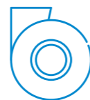
Vertical Fan Discharge
